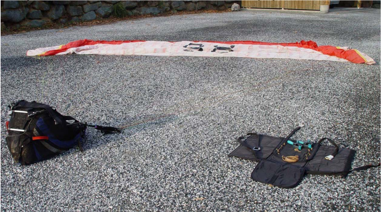
Abb. 3 links das eingehängte Gurtzeug im Hintergrund der ausgebreitete Schirm mit der Unterseite nach oben
