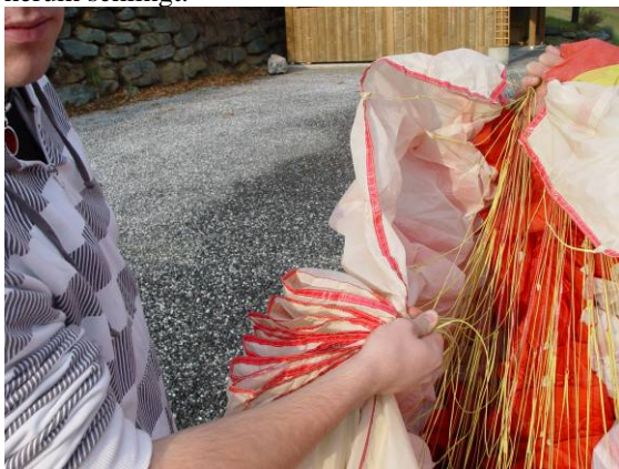
Abb. 18 die letzten Bremsleinenanlenkungen freilassen
