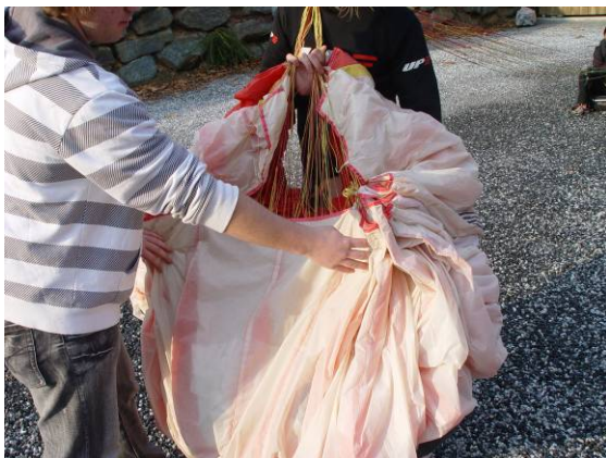
Abb. 32 Schirm gegen den Uhrzeigersinn zurückgedreht
