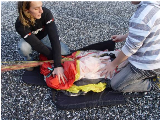
Abb. 38 langsam schließen und dabei nicht verdrehen
