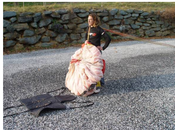
Abb. 33 das Deckblatt ist nach oben eingefalzen
