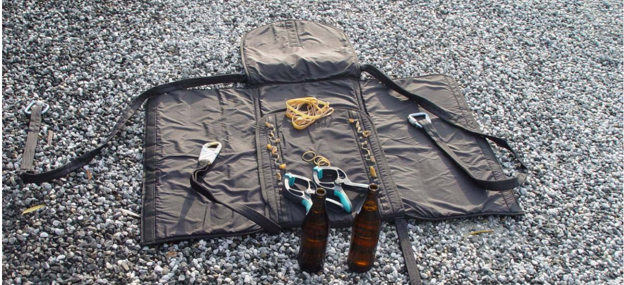
Abb. 1 D-Bag, auf dem D-Bag Deckblatt liegen Gummiringerl und Montageklebmen, davor die obligatorische Verpflegung
