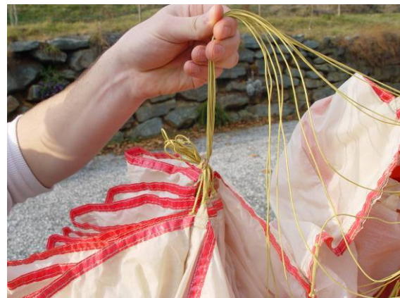
Abb. 20 Schlaufe fest umschlingen
