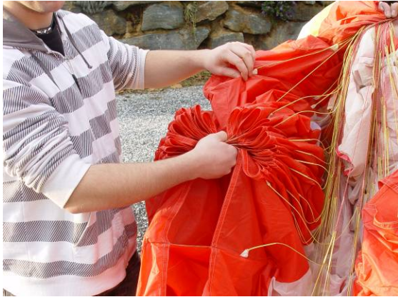
Abb. 28 keine Zelle auslassen
